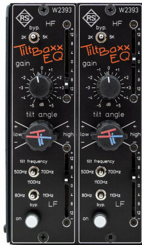
Der W2393 TiltBaxxEQ kombiniert ein Baxandall-Filter mit einem Neigungsfilter, auch Klangwaage genannt.
